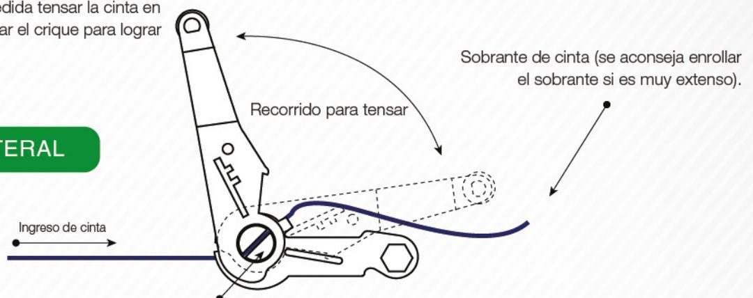
IMPORTANTE: La cantidad de vueltas del eje del crique al tensar no debe superar 2 giros completos (720°), ya que el espesor de la cinta enrollada en él, puede trabar el sistema de rotación.
