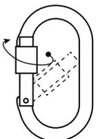
El perno vuelve automáticamente a su posición original al soltarlo, luego enrosque nuevamente la traba de seguridad.
